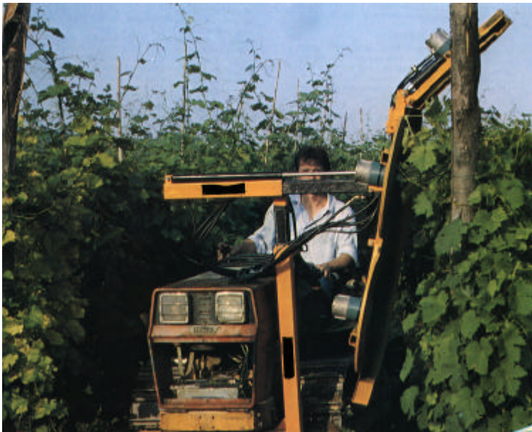
Cimatrice con motori elettrici
