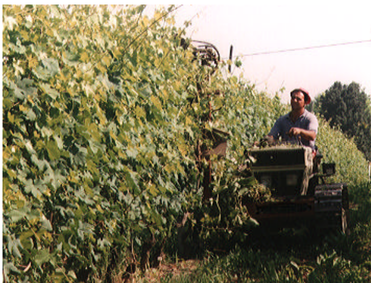
Cimatrice con rotori idraulici a lama e controlama
