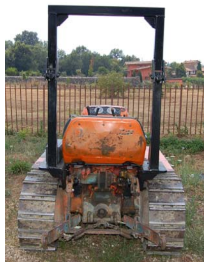
Figura 9. Struttura di protezione per trattori a cingoli modello 605 e derivati
