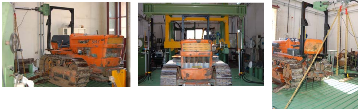
Figura 10. Fasi della prova. Da sinistra verso destra: spinta laterale, schiacciamento e spinta longitudinale
