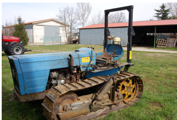
Figura 10. Struttura di protezione per trattori a cingoli modello Landini 6500C e simili
