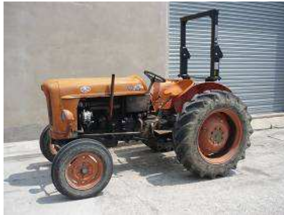
Figura 13. Struttura di protezione per trattori a ruote a carreggiata standard modello Fiat 411R e simili
