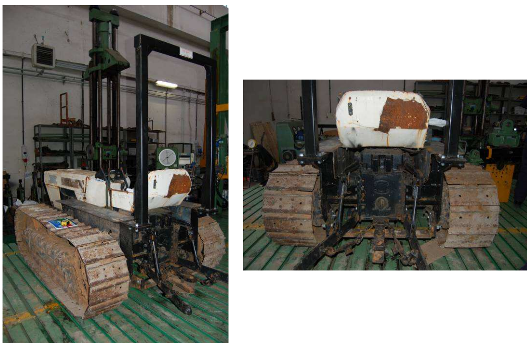
Figura 14. Struttura di protezione per trattori a cingoli modello Lamborghini C653 e simili
