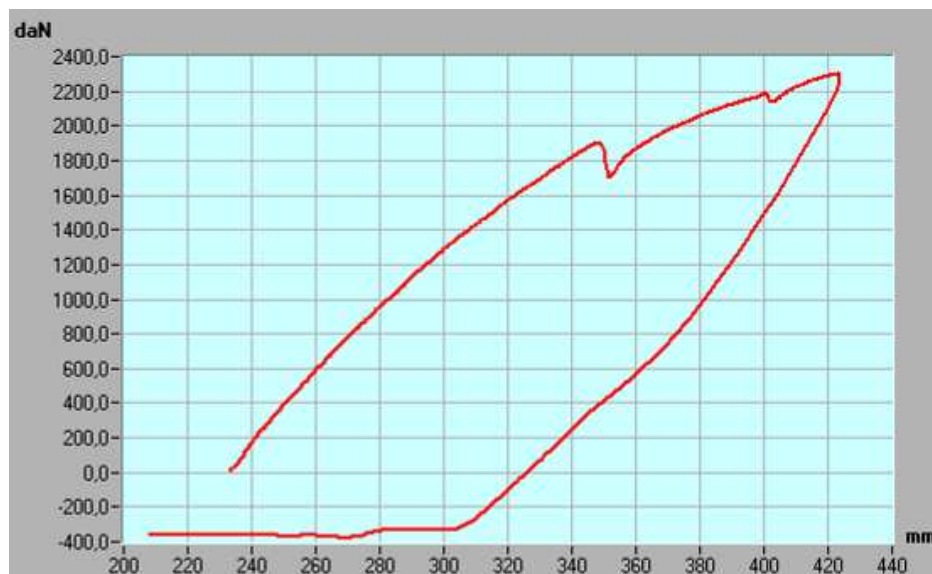
Figura 15. Spinta laterale lato sinistro
