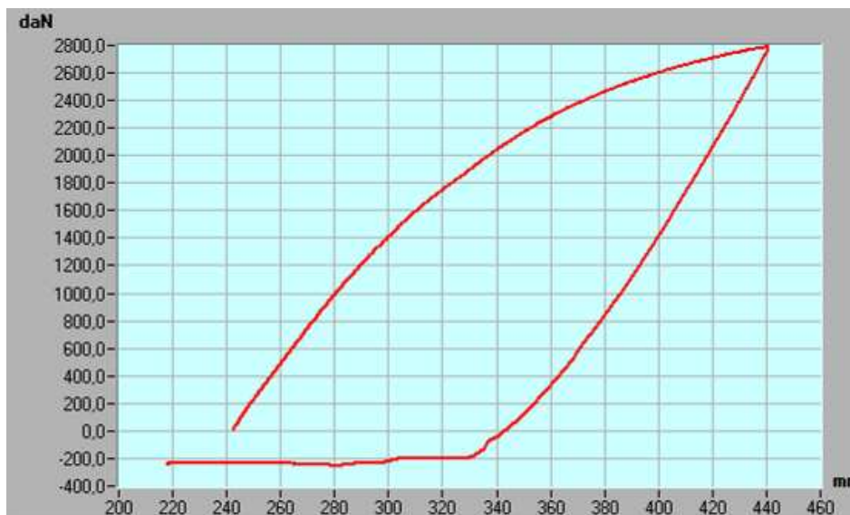
Figura 15. Spinta laterale lato sinistro
