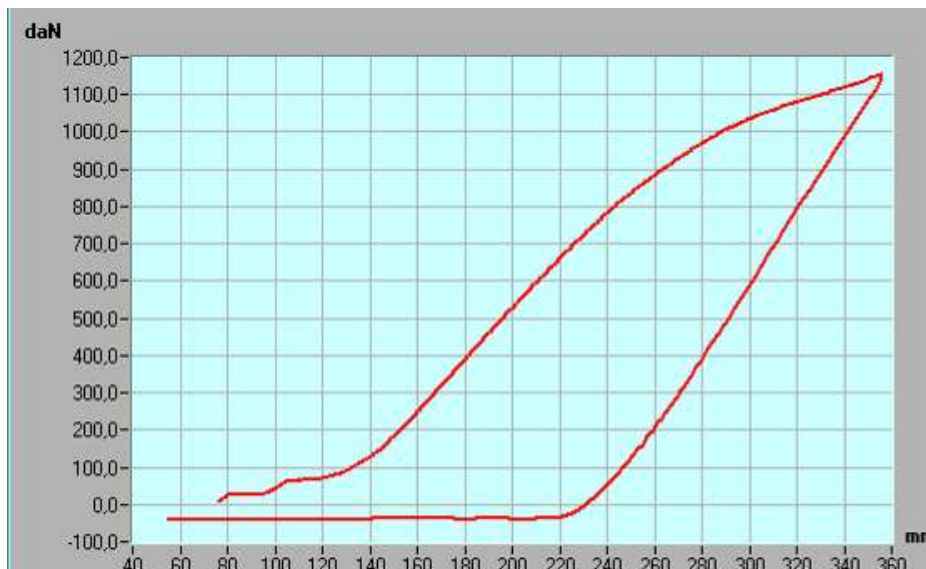
Figura 12. Spinta posteriore lato destro
