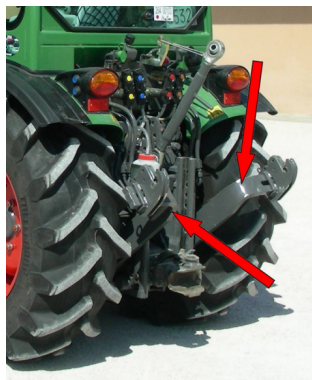
Fig. 12. I bracci inferiori devono evidenziare la conformazione originale, lineare o curvilinea, senza deformazioni visibili, ammaccature o cricche nel piano orizzontale o in quello verticale
