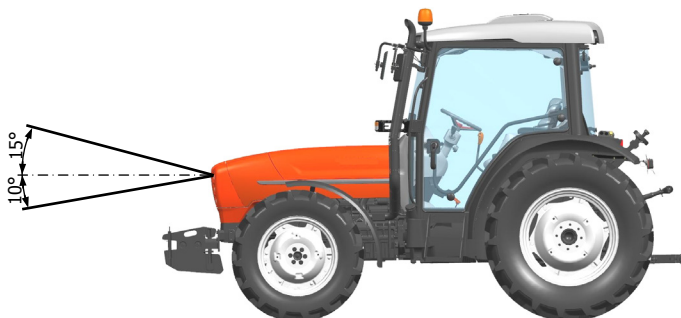
Fig. 16. Angoli verticali dei proiettori anabbaglianti
