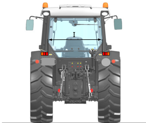
Fig. 22. Posizione in larghezza delle luci di arresto.
