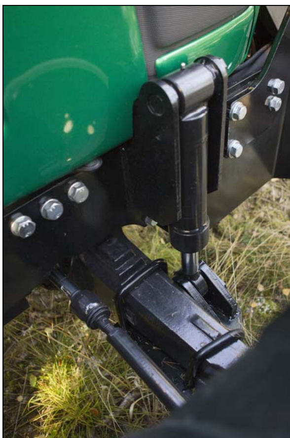
Esempio di sistema di stabilizzazione dell'assale anteriore
