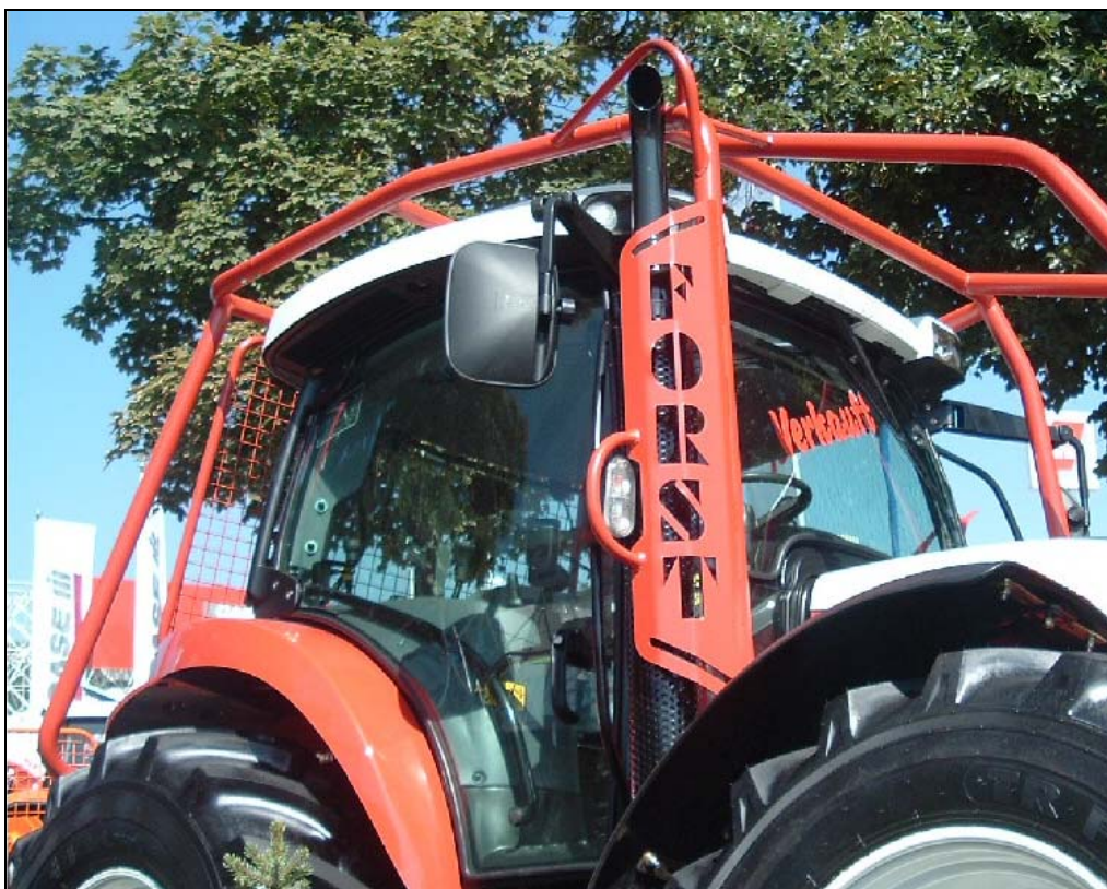
Esempio di griglia di protezione del silenziatore
