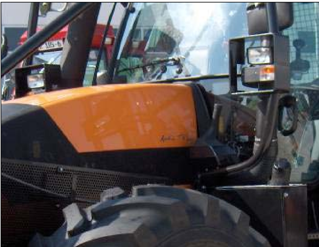
Esempio di protezione dei fari di lavoro tramite struttura metallica
