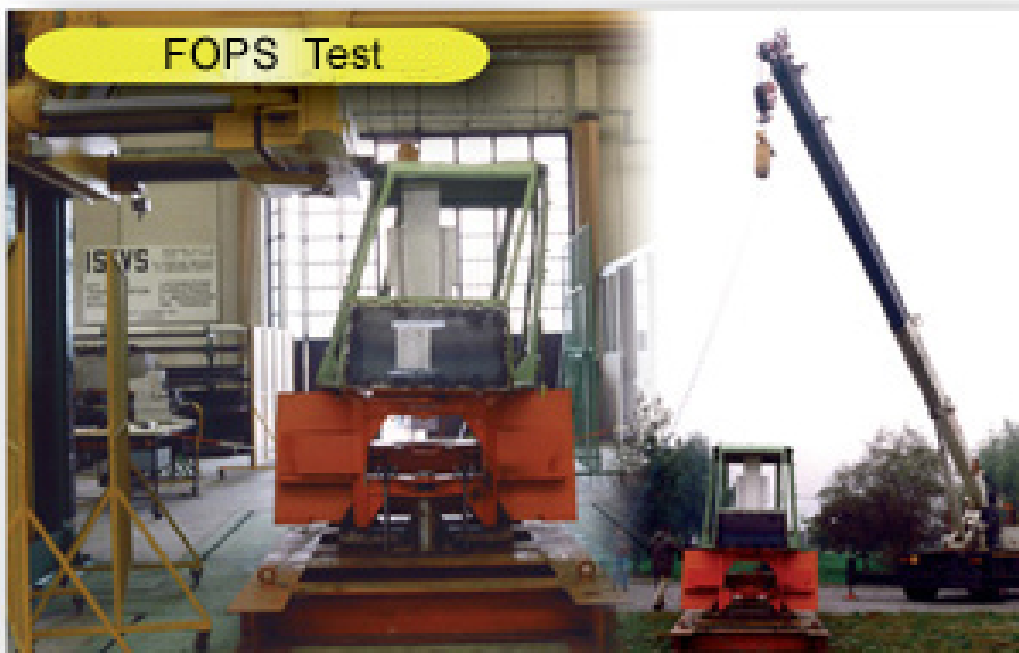
Esempio di prova FOPS
