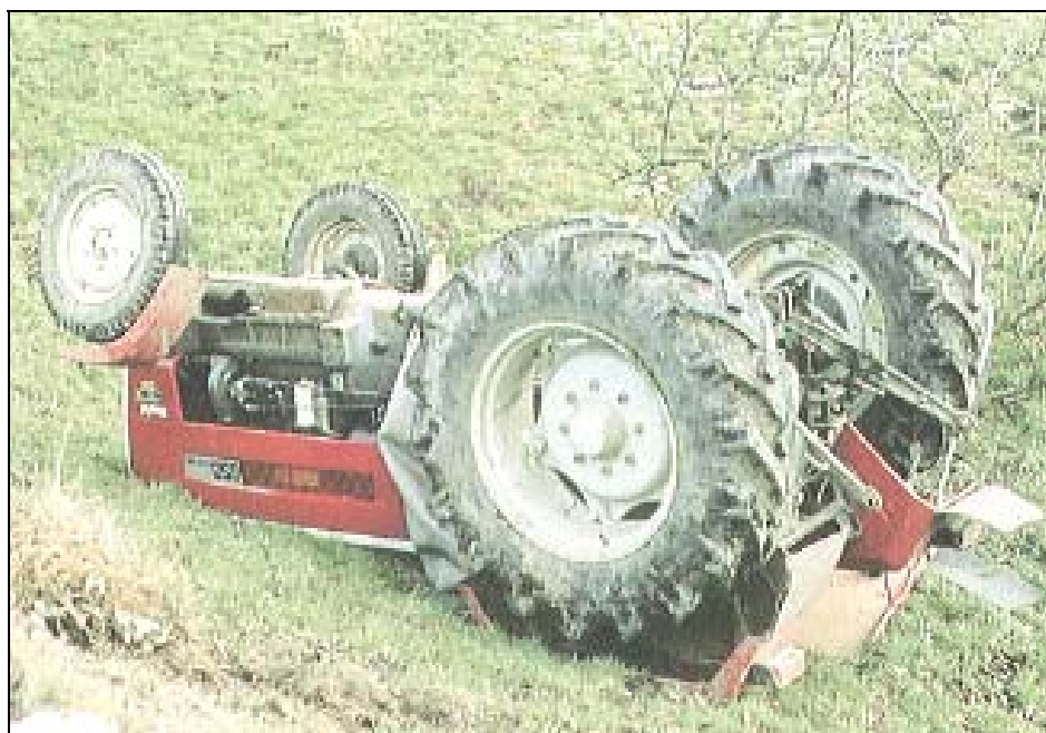
Ribaltamento di trattore non dotata di ROPS
