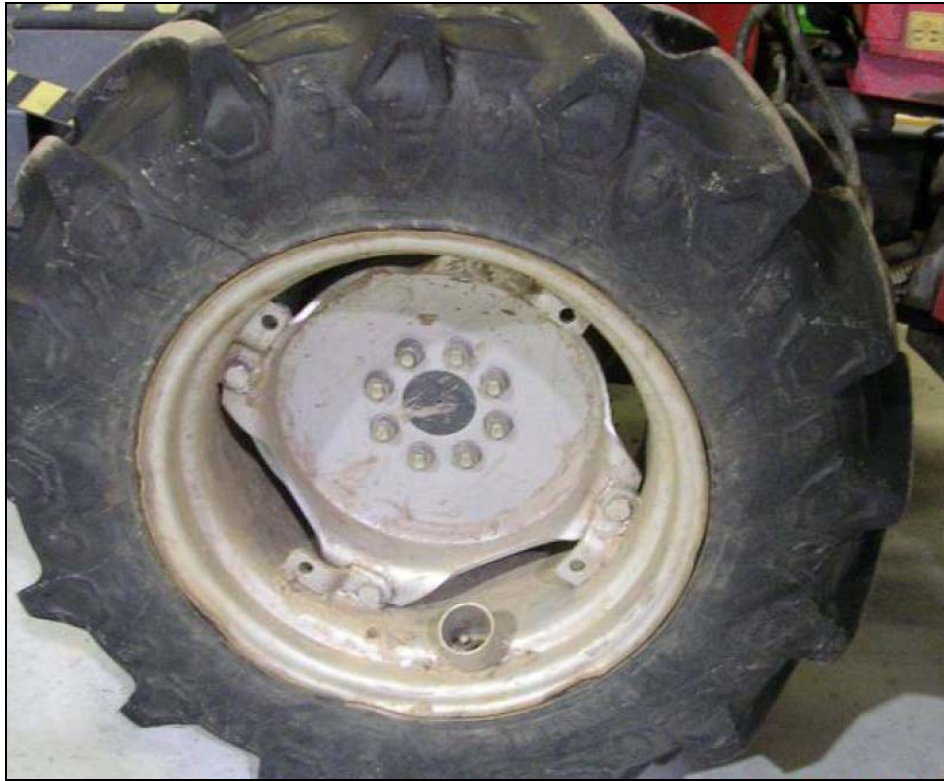
Esempio di protezione della valvola di gonfiaggio
