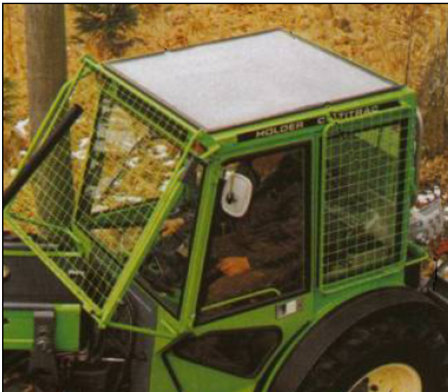
Esempi di schermatura a griglia della cabina di guida
