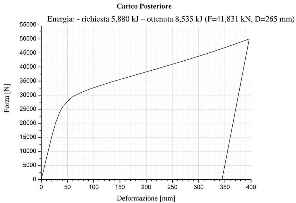
Figura 9. Carico posteriore: diagramma Forza vs. Deformazione
