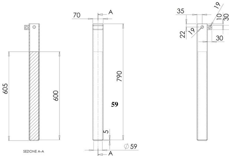
Figura 2. Dettaglio del montante con rinforzo interno
