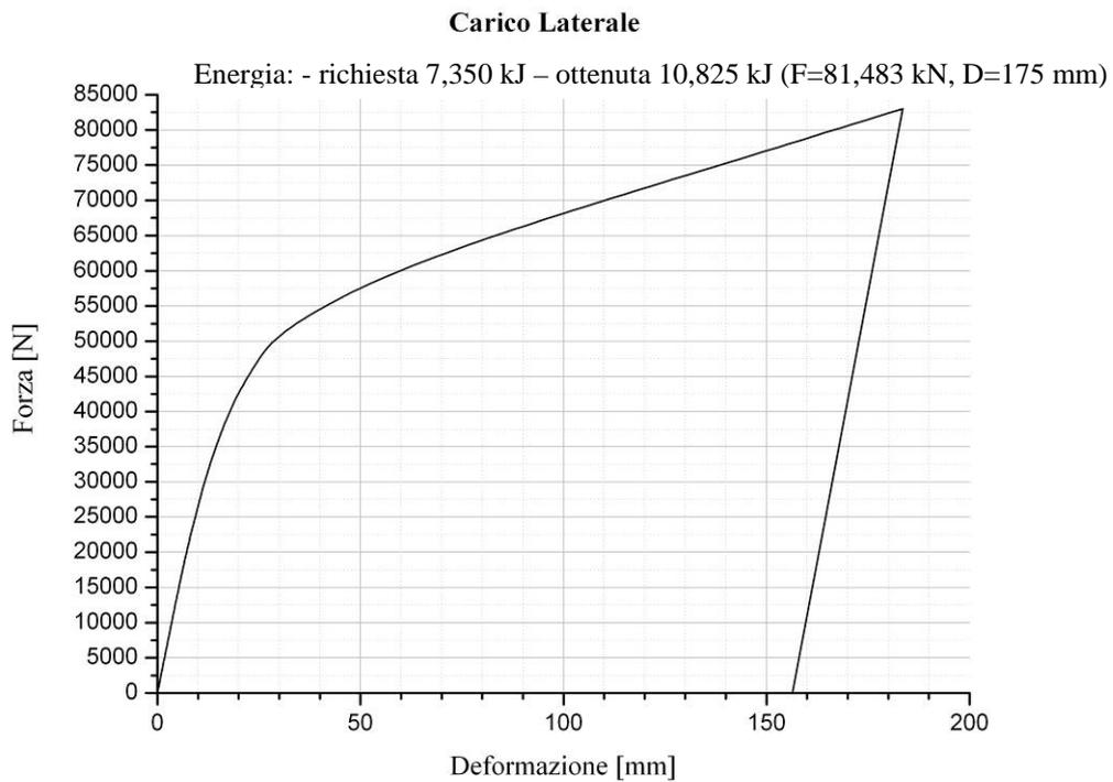
Figura 11. Carico laterale: diagramma Forza vs. Deformazione
