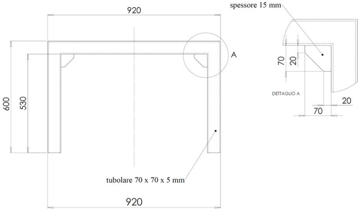
Figura 3. Dettaglio dell'arco superiore
