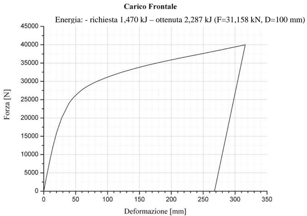
Figura 13. Carico frontale: diagramma Forza vs. Deformazione
