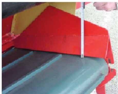
Figura21. Esempi di protezione applicata al nastro trasportatore
