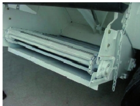
Figura21. Esempi di protezione applicata al nastro trasportatore
