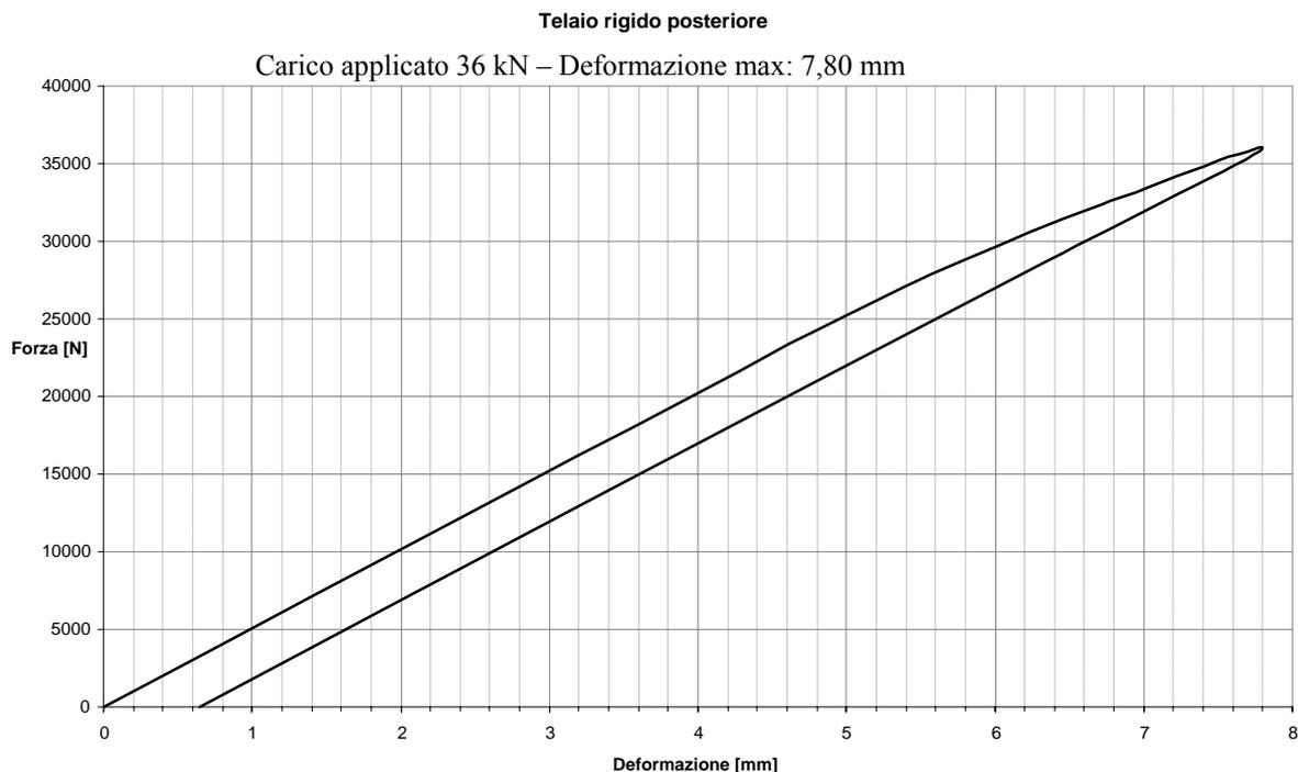
Figura 17. Telaio rigido posteriore: diagramma Forza vs. Deformazione
