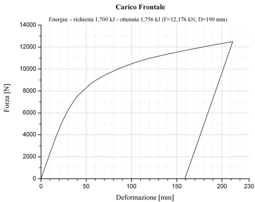
Figura 12. Carico frontale: diagramma Forza vs. Deformazione
