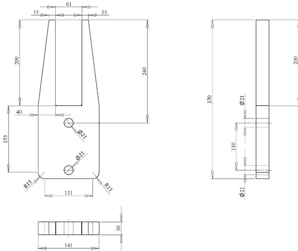
Figura 3. Piastra interna di collegamento per telaio fisso
