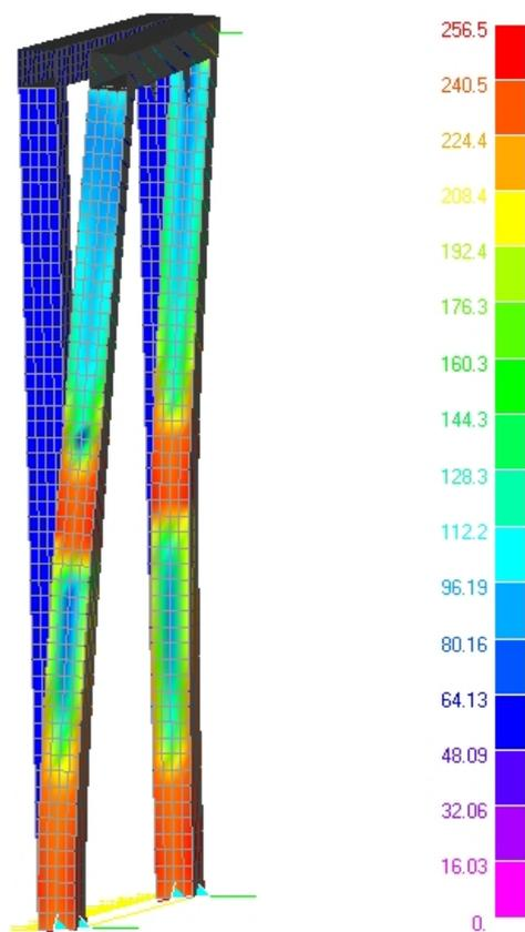
Figura 11. Carico frontale: diagramma a falsi colori della tensione [MPa]
