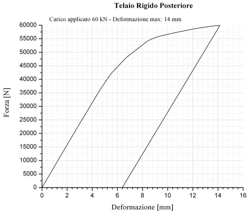
Figura 17. Telaio rigido posteriore: diagramma Forza vs. Deformazione
