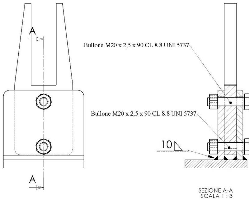
Figura 5. Assieme dell'elemento di collegamento per telaio fisso
