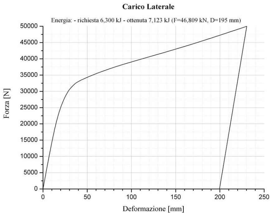
Figura 14. Carico laterale: diagramma Forza vs. Deformazione
