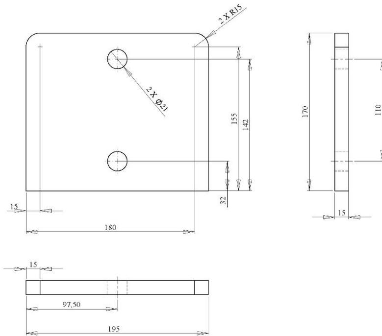
Figura 4. Piastra laterale interna per telaio fisso
