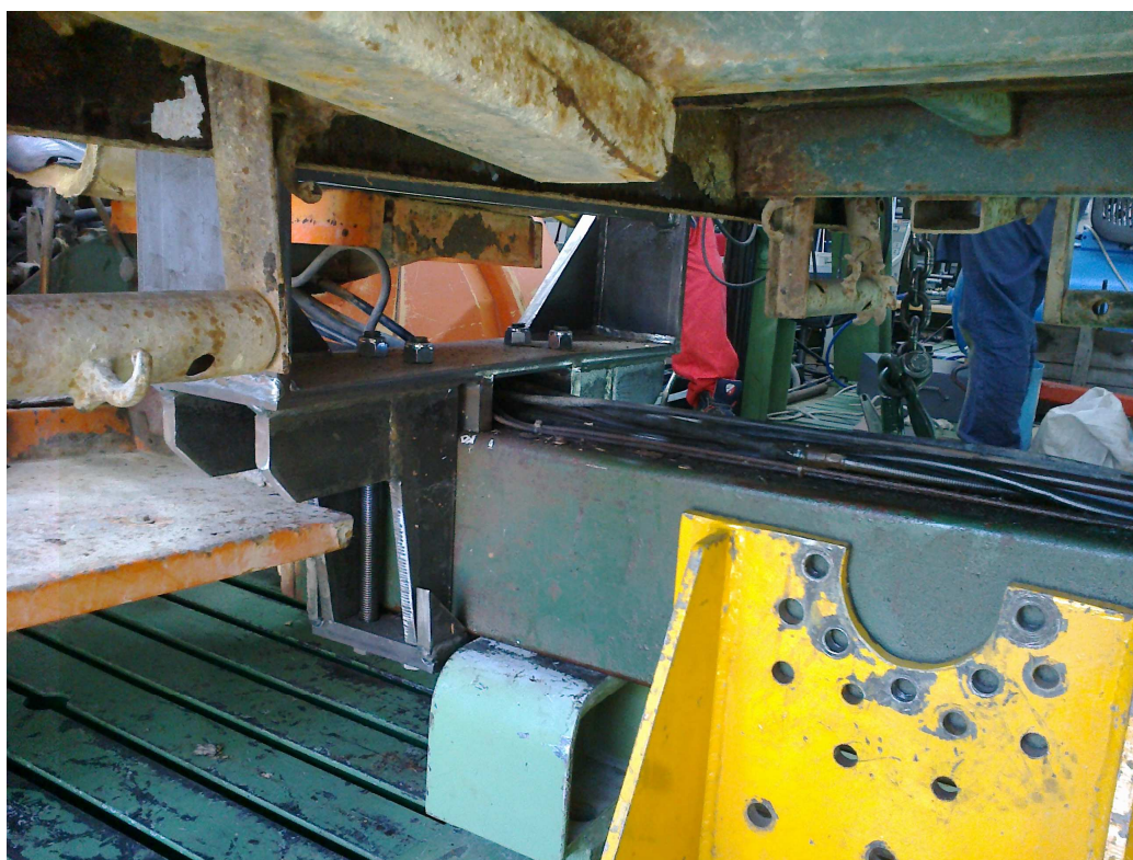
Figura 4. Collegamento del dispositivo di attacco alla motoagricola.
