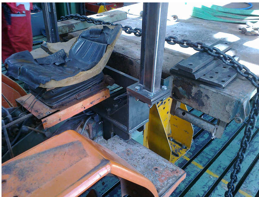
Figura 1. Struttura di protezione contro il rischio di capovolgimento a due montanti posteriori per motoagricola Carraro Tigrotto Transcar e simili. Componenti principali (in alto), dettagli del dispositivo di attacco sul prototipo (in basso).
