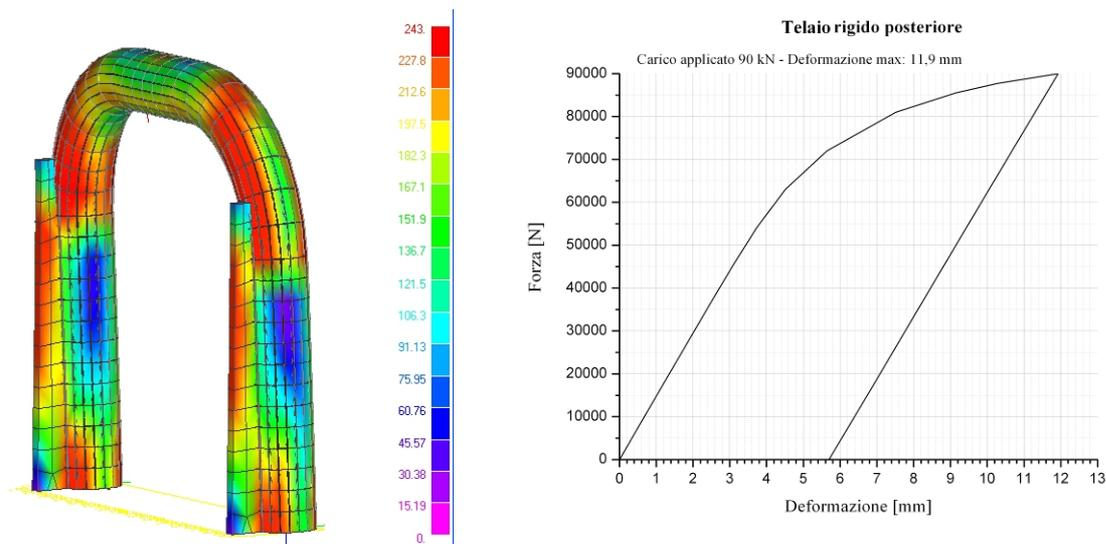
Figura 14. Telaio rigido posteriore: diagramma a falsi colori della tensione [MPa] e diagramma Forza vs. Deformazione
