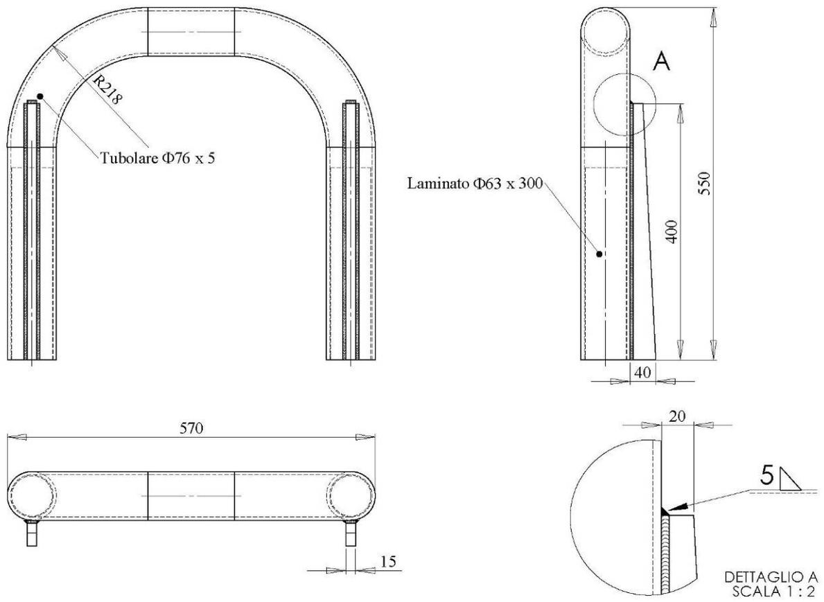
Figura 1. Telaio rigido posteriore
