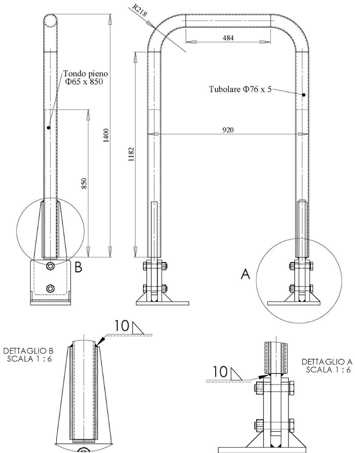
Figura 2. Telaio di protezione anteriore fisso
