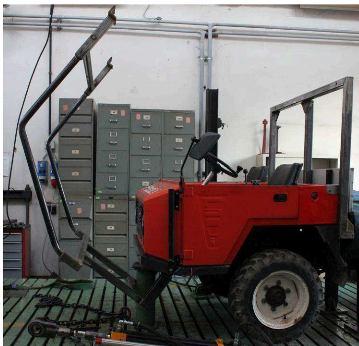
Figura 1. Struttura di protezione in caso di capovolgimento per la motoagricola Paoli FP e simili. Componenti principali (in alto), articolazione della parte anteriore del telaio (in basso).
