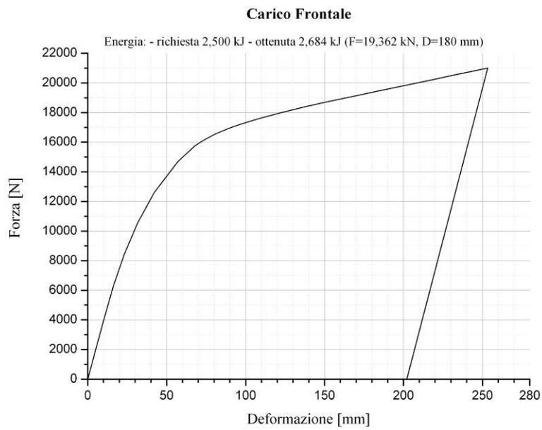
Figura 11. Carico frontale: diagramma Forza vs. Deformazione
