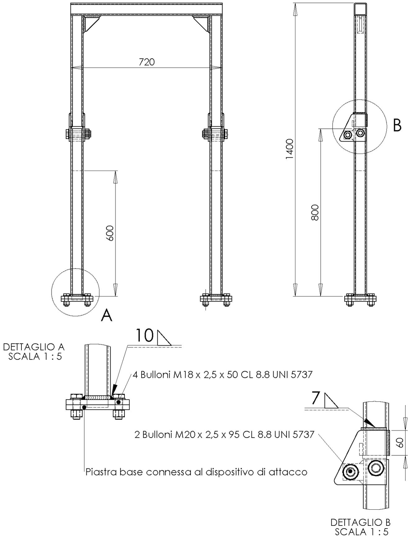
Figura 1. Telaio di protezione posteriore abbattibile
