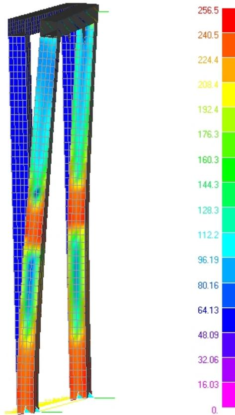
Figura 10. Carico frontale: diagramma a falsi colori della tensione [MPa]
