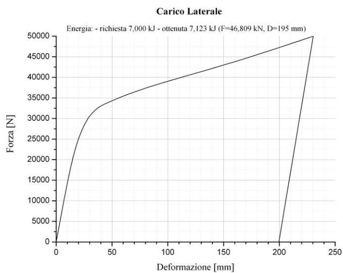
Figura 13. Carico laterale: diagramma Forza vs. Deformazione
