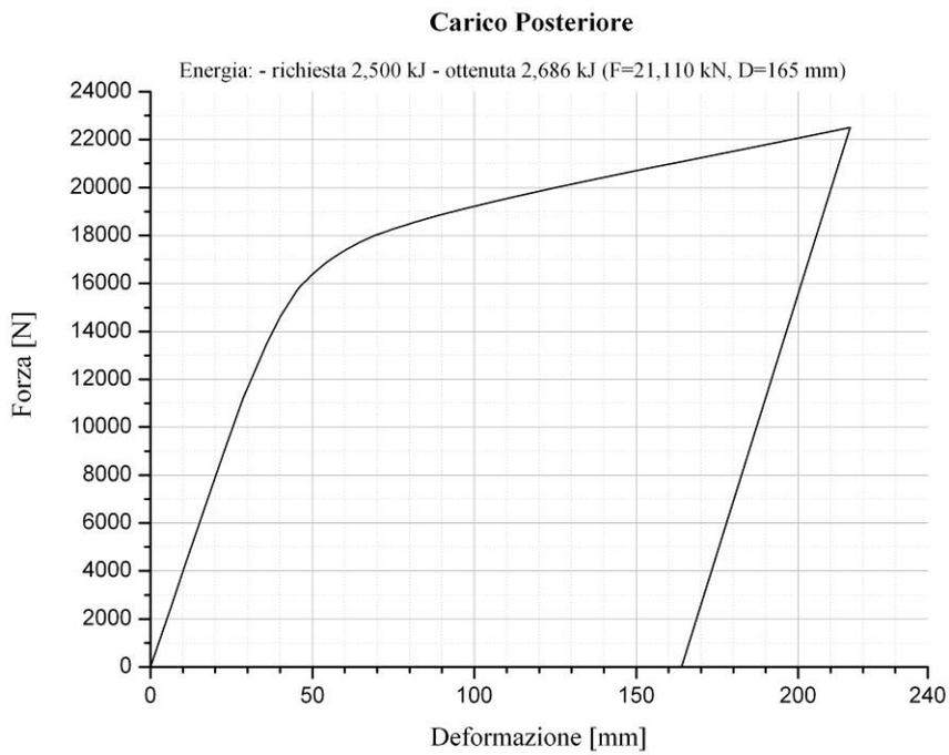
Figura 9. Carico posteriore: diagramma Forza vs. Deformazione
