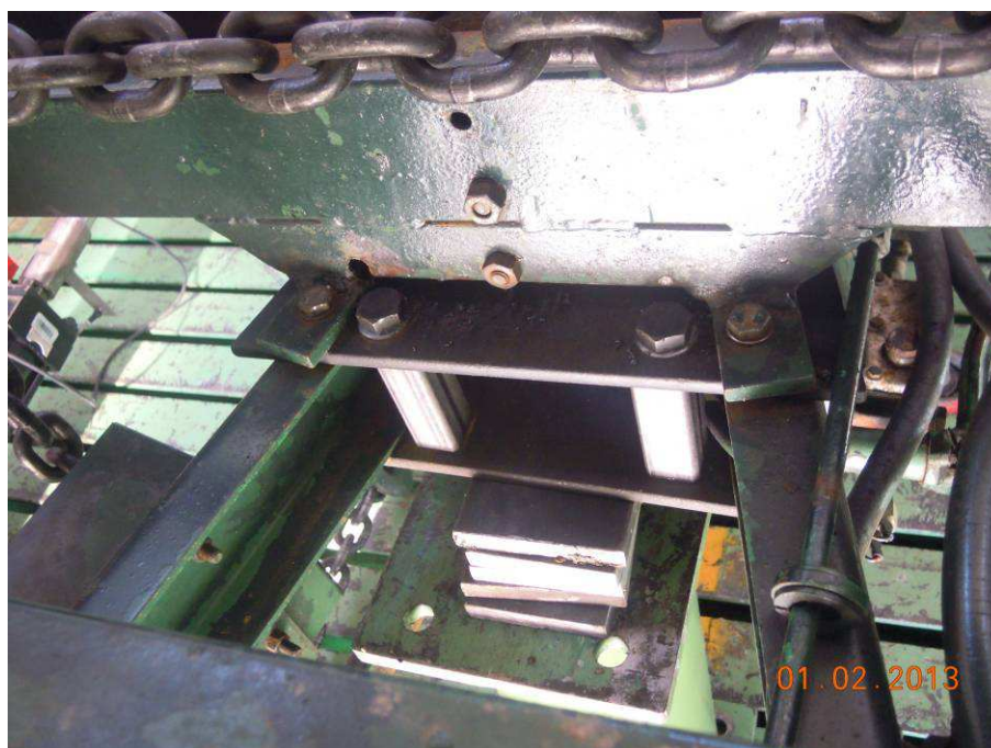
Figura 5. Collegamento del dispositivo di attacco alla struttura portante della motoagricola.
