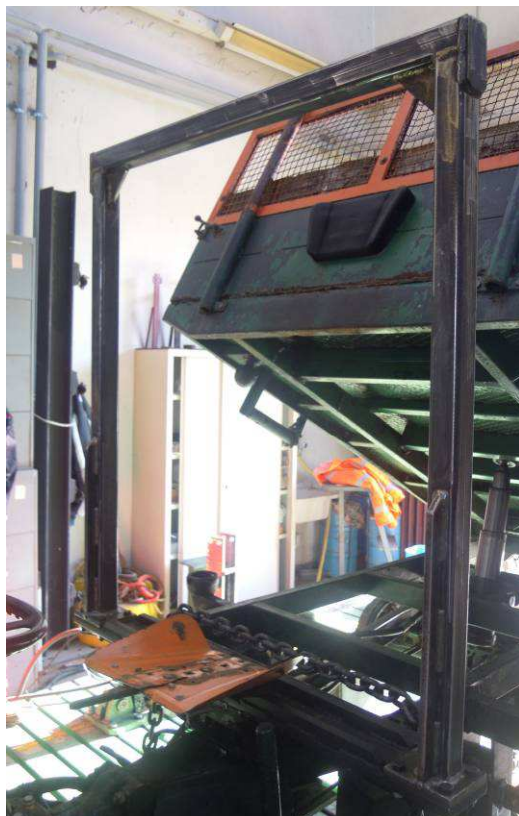
Figura 1. Struttura di protezione in caso di capovolgimento a due montanti posteriori per motoagricola Goldoni 526 e simili. Componenti principali (in alto), immagine del prototipo (in basso).
