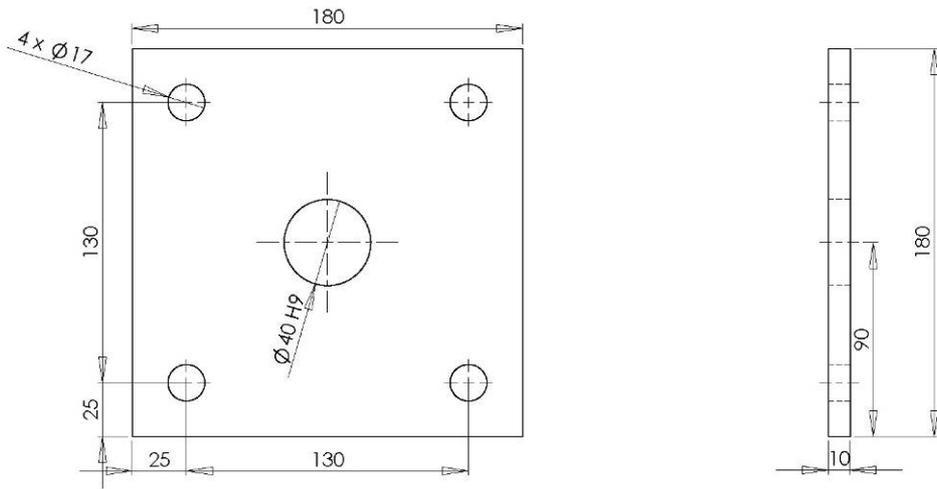
Figura 6. Piastra alla base del telaio
