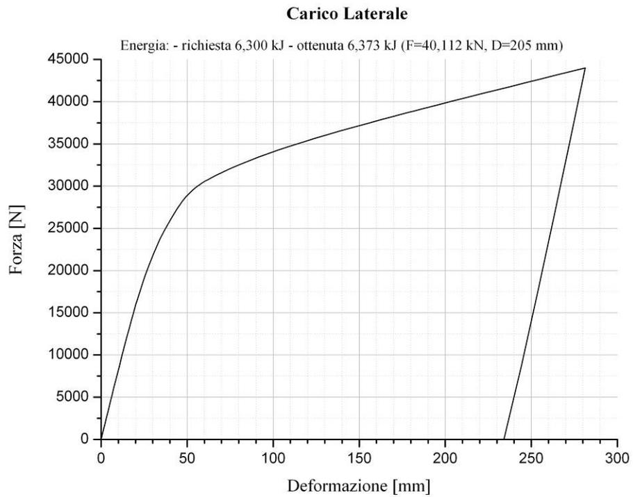
Figura 12. Carico laterale: diagramma Forza vs. Deformazione
