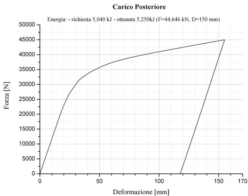
Figura 10. Carico posteriore: diagramma Forza vs. Deformazione
