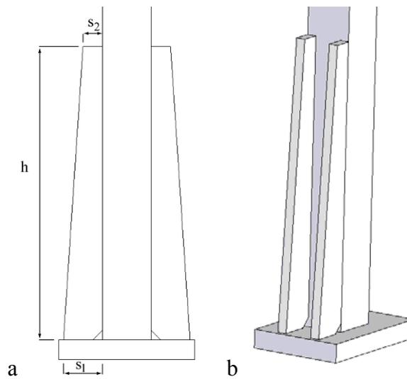
Figura 8. Disposizione flangie di rinforzo
