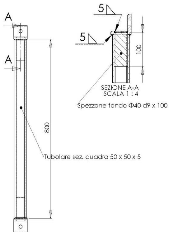
Figura 4. Traversa trasversale
