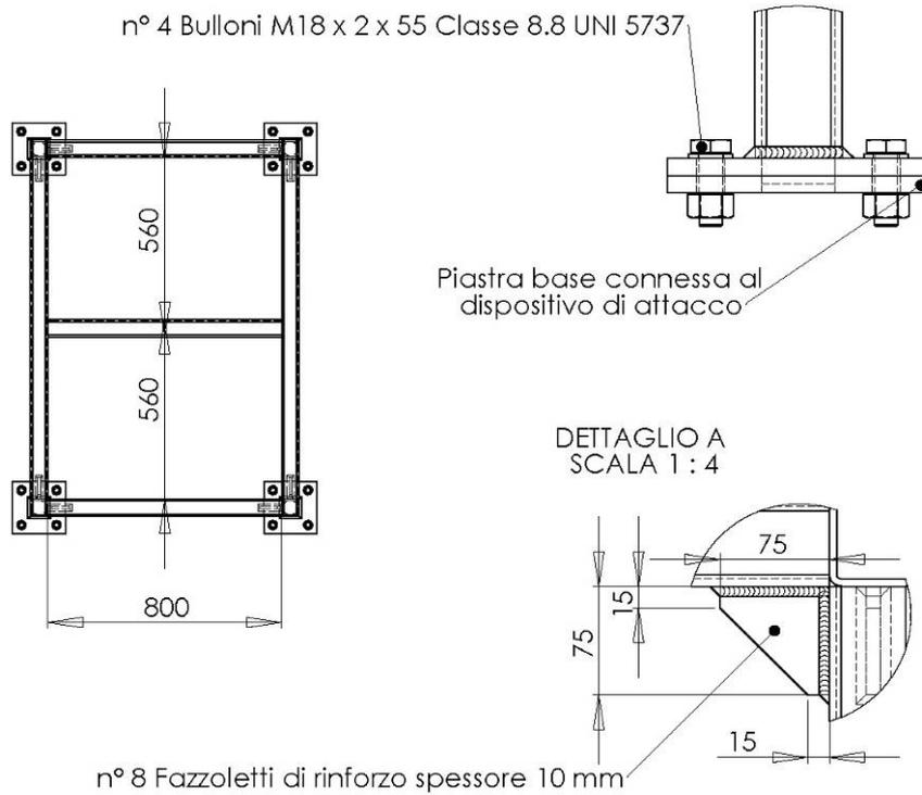
Figura 2. Telaio di protezione a quattro montanti
