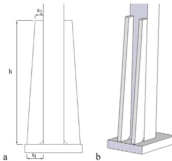
Figura 5. Disposizione flangie di rinforzo
