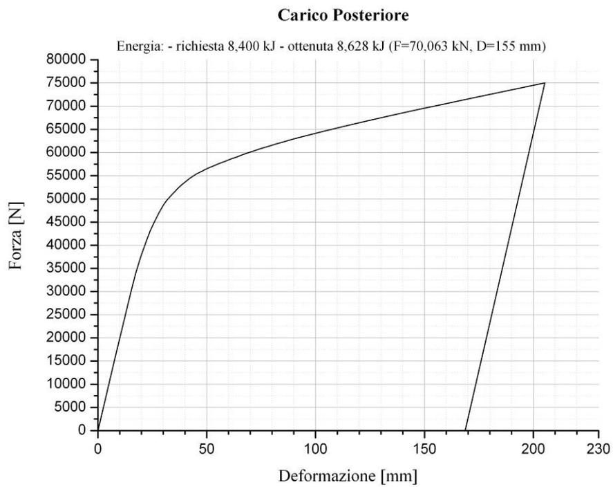
Figura 7. Carico posteriore: diagramma Forza vs. Deformazione
