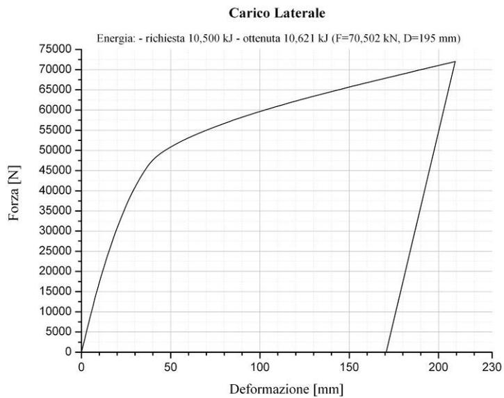
Figura 9. Carico laterale: diagramma Forza vs. Deformazione
