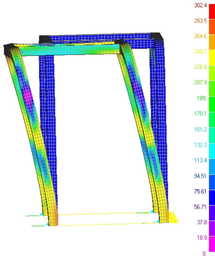
Figura 11. Carico laterale: diagramma a falsi colori della tensione [MPa]
