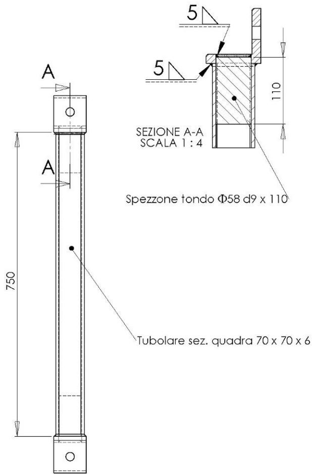
Figura 4. Traversa trasversale
