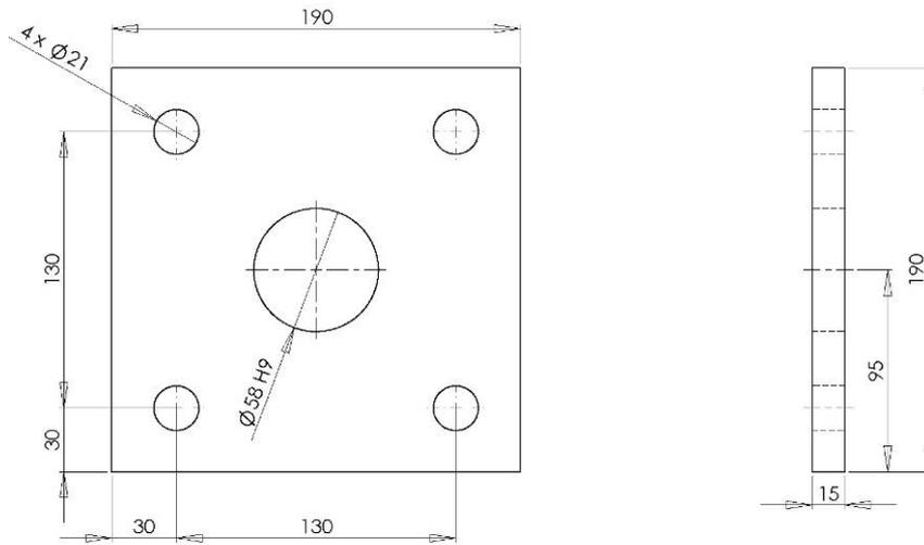
Figura 6. Piastra alla base del telaio
