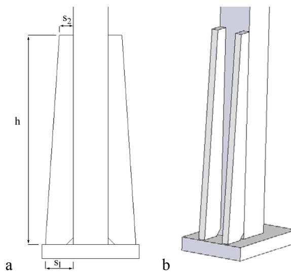
Figura 8. Disposizione flangie di rinforzo
