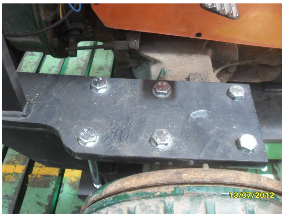
Figura 6. Dispositivo di attacco: collegamenti bullonati.
