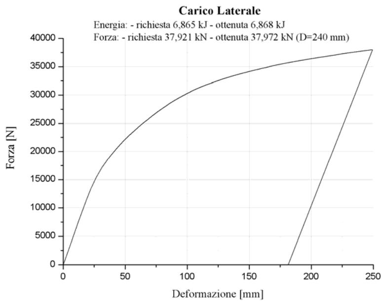
Figura 10. Carico laterale: diagramma Forza vs. Deformazione
