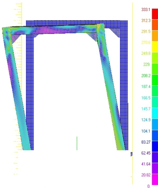
Figura 11. Carico verticale: diagramma a falsi colori della tensione [MPa]
