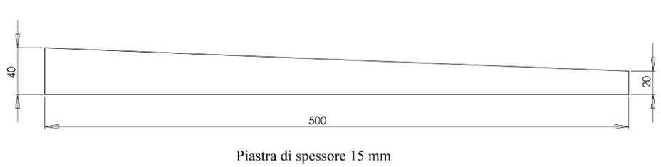
Figura 5. Flangia di rinforzo dei montanti del telaio (due per montante)
