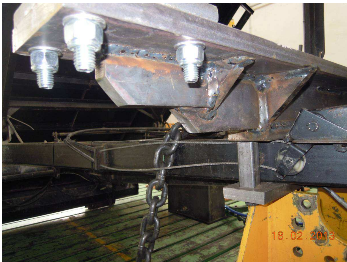
Figura 6. Dispositivo di attacco: collegamenti bullonati.
