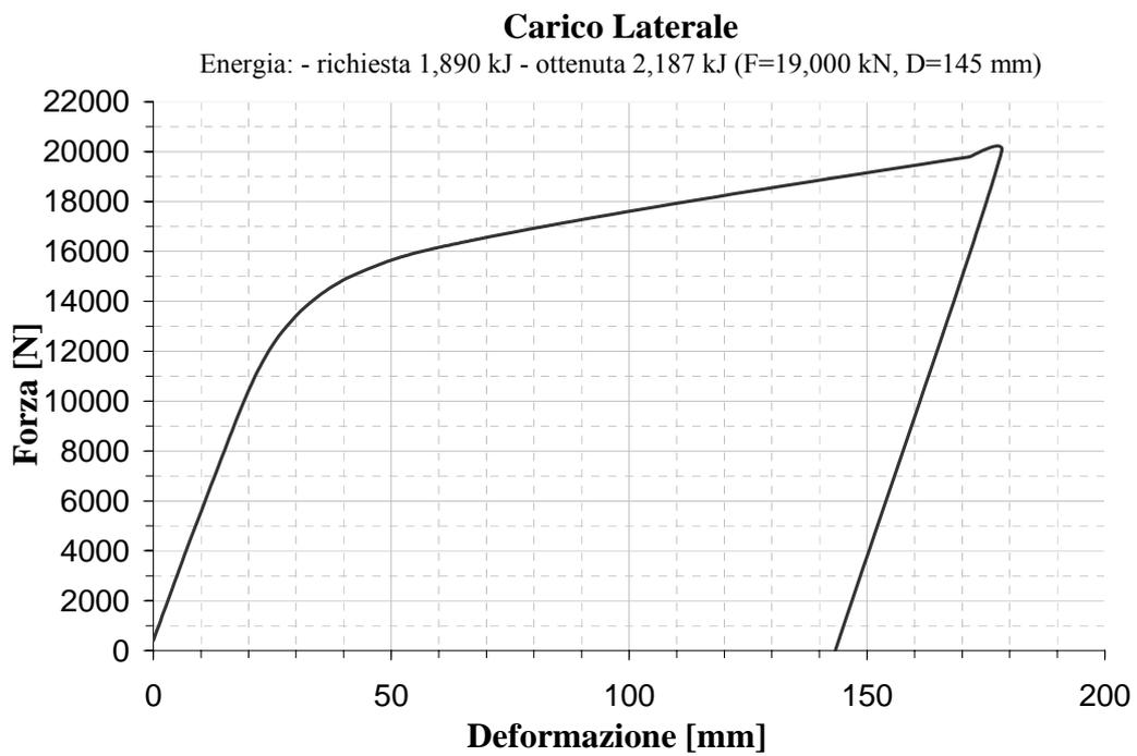
Figura 14. Carico laterale: diagramma Forza vs. Deformazione
