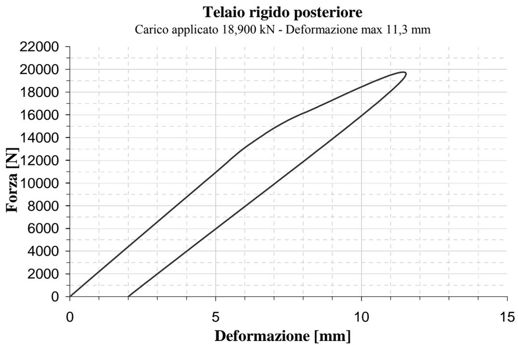
Figura 17. Telaio rigido posteriore: diagramma Forza vs. Deformazione
