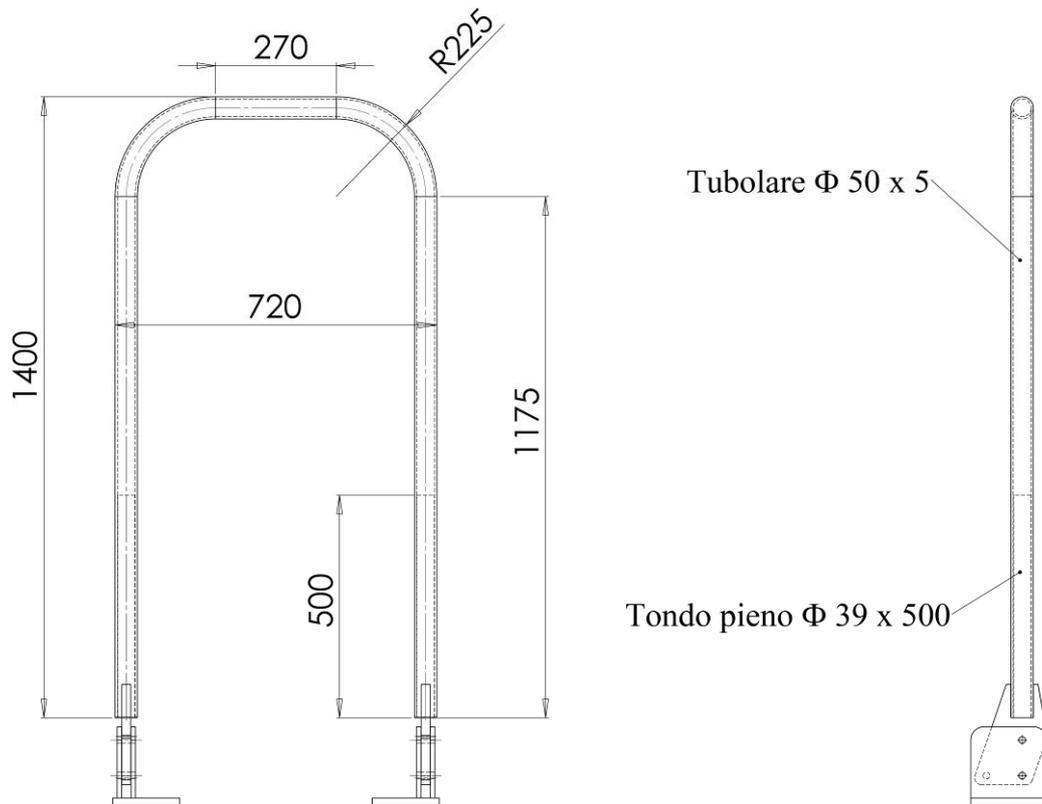
Figura 2. Telaio di protezione anteriore abbattibile
