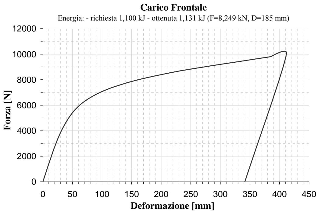
Figura 12. Carico frontale: diagramma Forza vs. Deformazione
