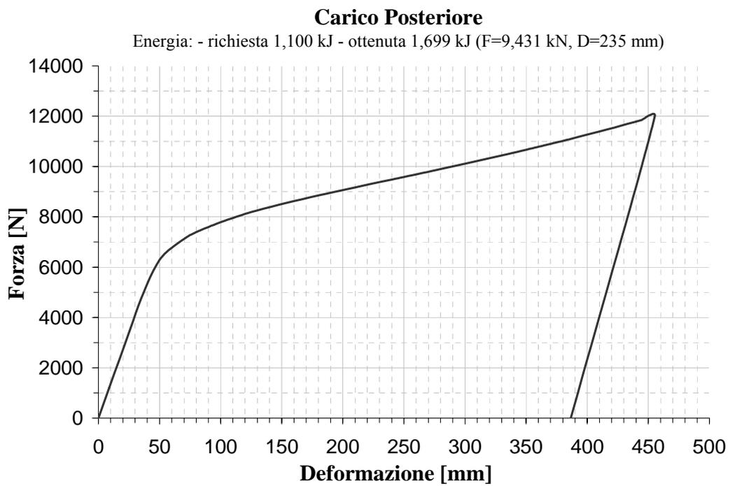
Figura 10. Carico posteriore: diagramma Forza vs. Deformazione
