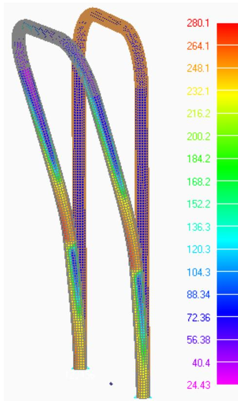
Figura 9. Carico posteriore: diagramma a falsi colori della tensione [MPa]
