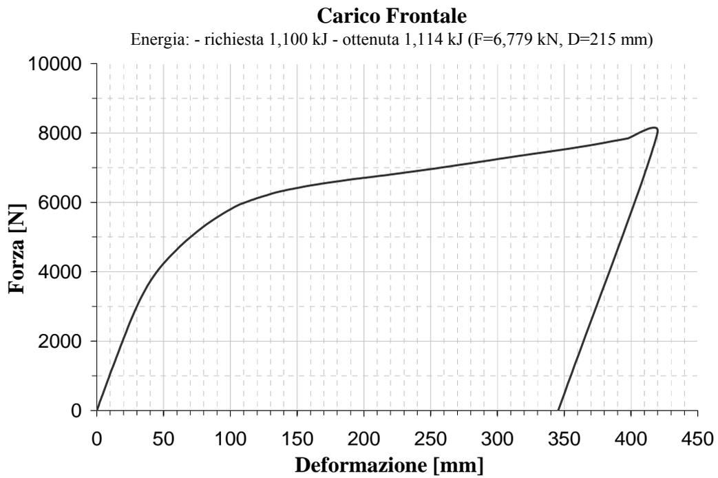
Figura 11. Carico frontale: diagramma Forza vs. Deformazione
