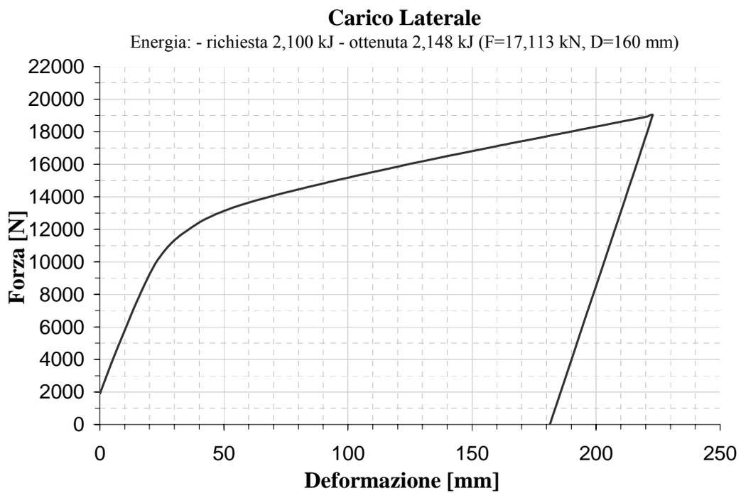
Figura 13. Carico laterale: diagramma Forza vs. Deformazione
