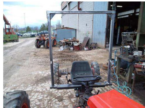
Figura 1. Struttura di protezione in caso di capovolgimento a due montanti posteriori per la motoagricola modello Valpadana VM 180 e simili: componenti principali.
