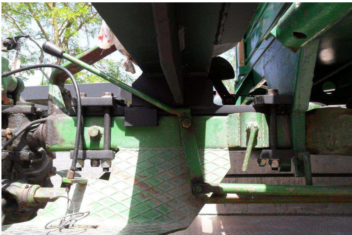
Figura 4. Collegamento del dispositivo di attacco lato sinistro alla motoagricola.
