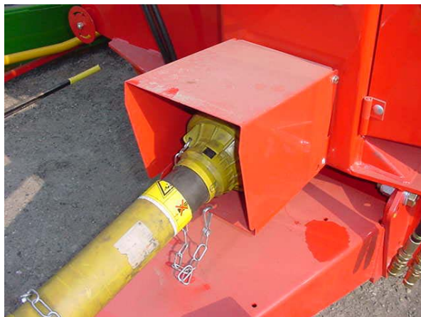
Sistema di trasmissione del moto protetto con albero cardanico e cuffia conformi e catenelle antirotazione
