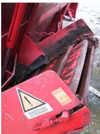
Tappeto di scarico non protetto
