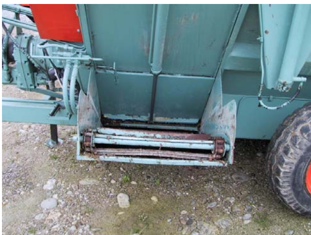
Tappeto di scarico non protetto
