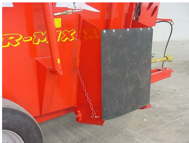
Adeguate protezioni del tappeto di scarico
