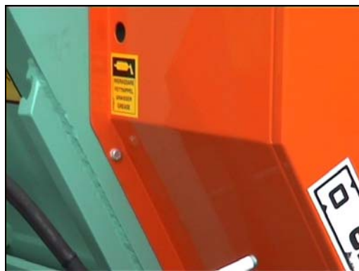
Trasmissione coperta da carter fisso
