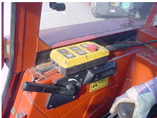
Comandi in cabina con teleflessibile
