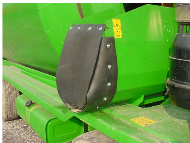
Adeguate protezioni del tappeto di scarico
