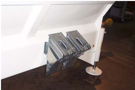
Cunei di blocco a bordo macchina
