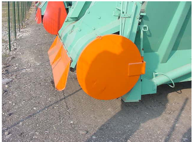
Adeguamento protezione fresa della macchina usata
