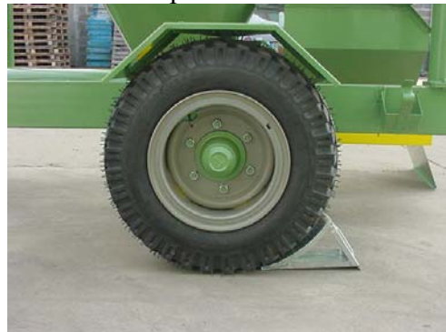
Cuneo di blocco posizionato alla ruota
