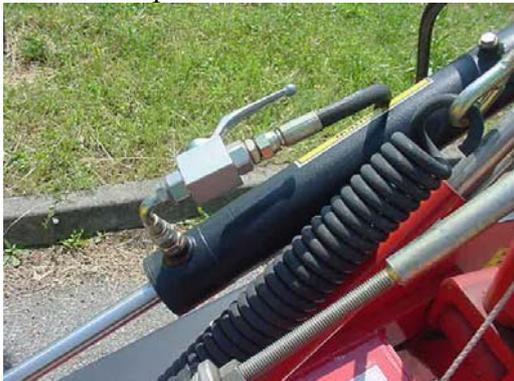
Dispositivo di blocco idraulico
