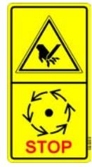
Pericolo di ferimento, aspettare che la macchina sia completamente ferma prima di avvicinarsi
