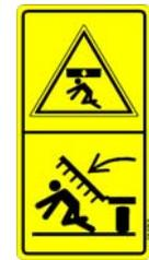
Pericolo di caduta di carichi sospesi, non sostare sotto a parti sollevate della macchina
