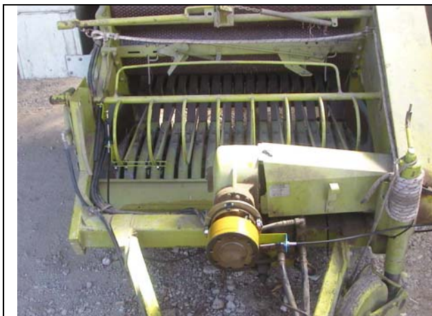
Disaccoppiatore Comer installato su imballatrice usata
