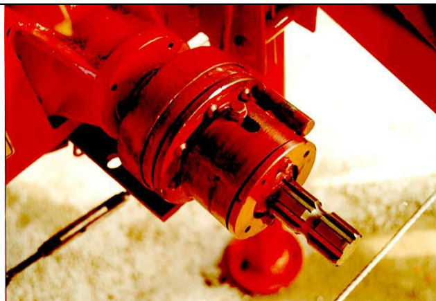
Disaccoppiatore Lerda installato su imballatrice usata
