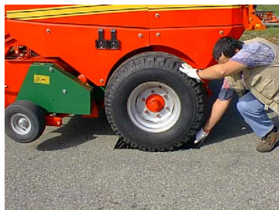
Inserimento cunei di blocco°
