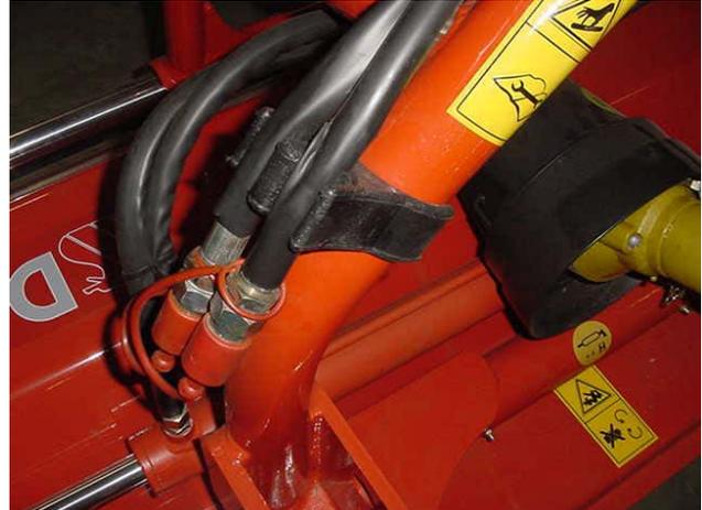
Supporto tubi idraulici
