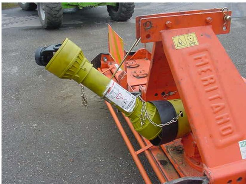
Sistema di trasmissione del moto ricondizionato con albero cardanico protetto, cuffia conforme, supporto a riposo dell'albero e catenelle antirotazione
