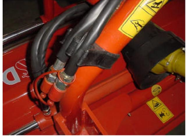
Supporto tubi idraulici
