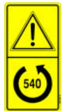
Verificare i giri ed il senso di rotazione della pdp della trattrice prima di inserire la trasmissione di potenza
