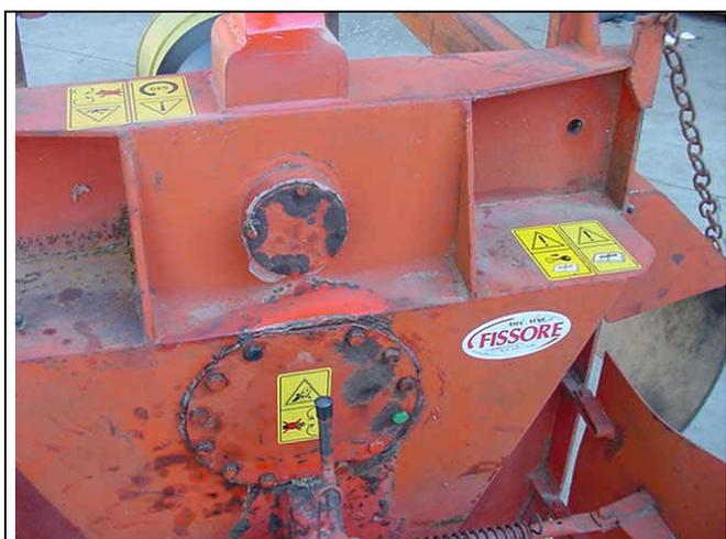
Le macchine, infine, devono essere dotate di idonei pittogrammi di sicurezza che inducano l'operatore a porre particolare attenzione, in prossimità dei punti evidenziati, nelle cui vicinanze sussiste un pericolo residuo.
