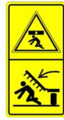
Pericolo di caduta di carichi sospesi, non sostare sotto a parti sollevate della macchina
