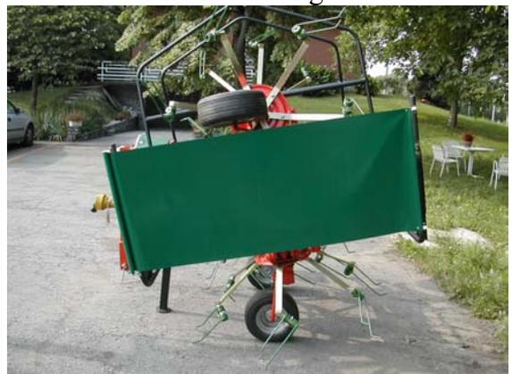
Esempio di protezione delle punte degli utensili di un ranghinatore mediante adozione di un riparo
