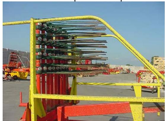
Esempio di protezione delle punte degli utensili di un ranghinatore
