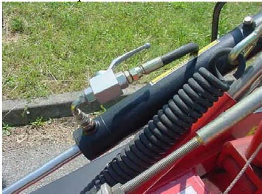
Dispositivo di blocco idraulico
