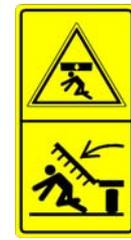
Pericolo di caduta di carichi sospesi, non sostare sotto parti sollevate della macchina
