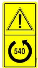
Verificare i giri ed il senso di rotazione della pdp della trattrice prima di inserire la trasmissione di potenza
