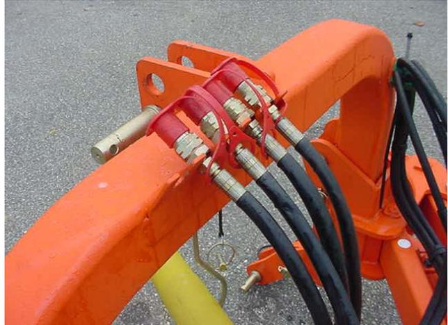
Supporto tubi idraulici
