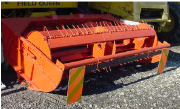
Testata di raccolta con barra distanziatrice frontale
