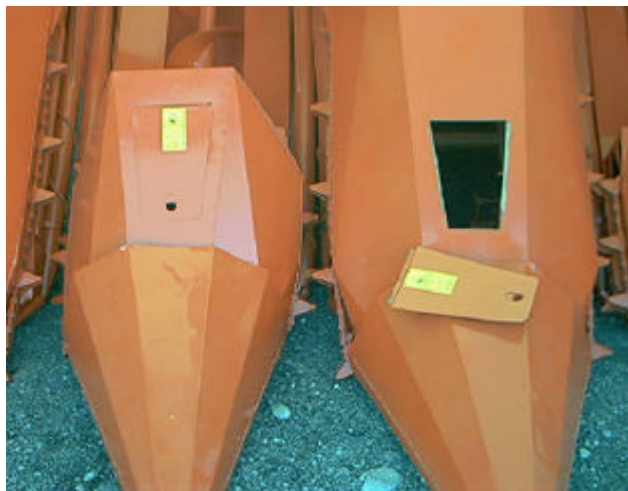
Carter di protezione non solidali alla macchina
