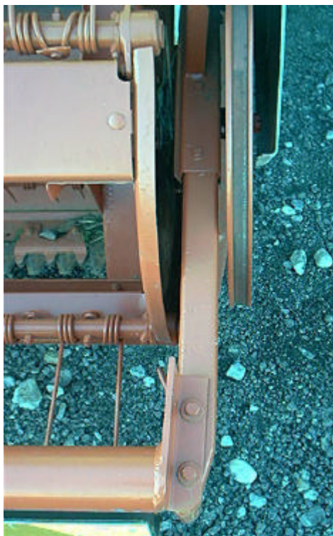
Distanza di sicurezza tra aspo e protezione laterale
