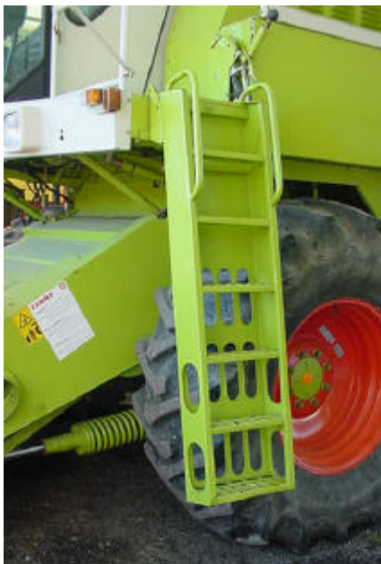
Scala protetta e gradini con superficie antisdrucciolevole
