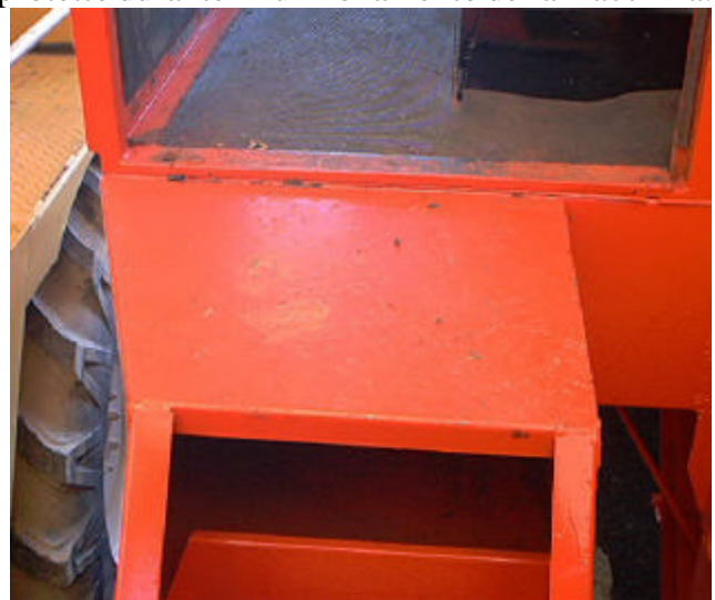
Piattaforma priva di protezioni
