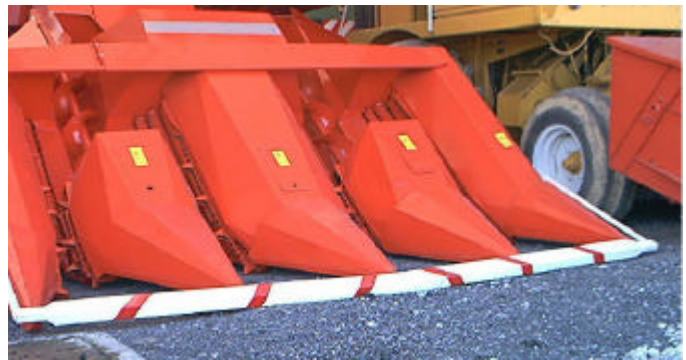
Testata raccolta mais con protezione per circolazione stradale
