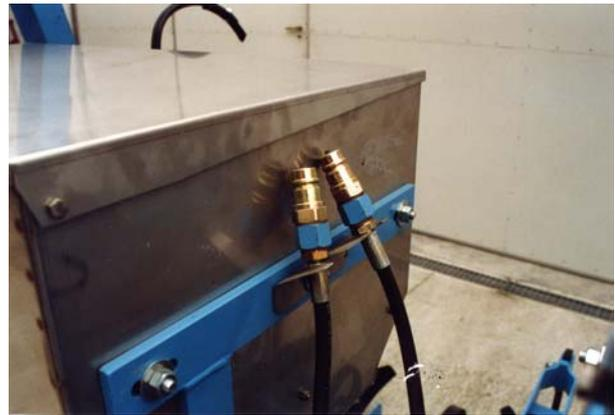
Supporto tubi idraulici
