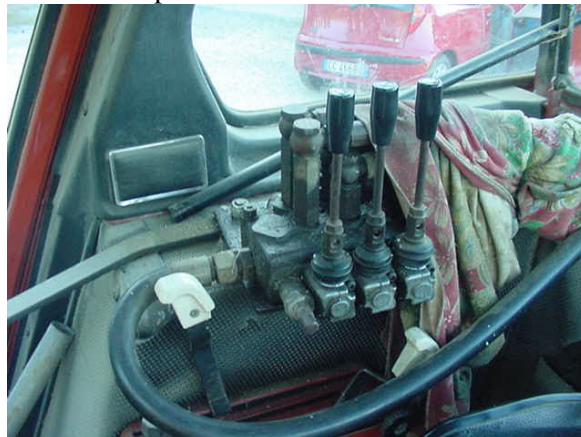
Esempio di console di comando senza protezione
