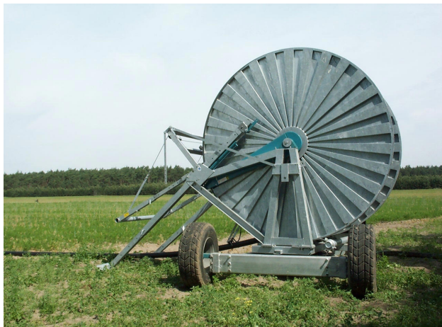
Parete laterale per la protezione del naspo in rotazione
