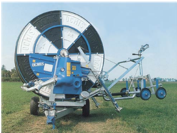
Parete laterale per la protezione del naspo in rotazione
