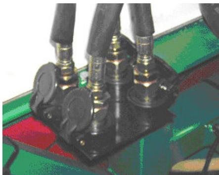
Dispositivo di supporto tubi idraulici
