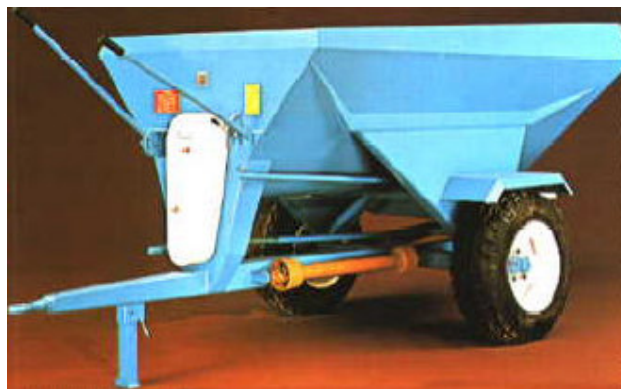
Fig. 2 – Spandiconcime con distributore a reazione centrifuga di tipo trainato
