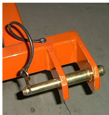
Fig. 20 - Spine antisfilo di sicurezza
