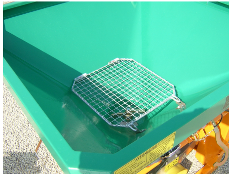
Fig. 16 – Griglia mobile nella tramoggia
