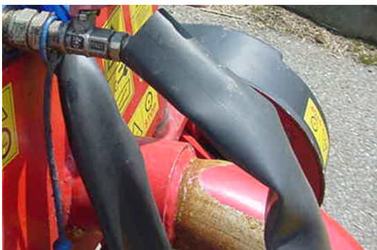
Fig. 11 - Protezione con guaina antiscoppio
