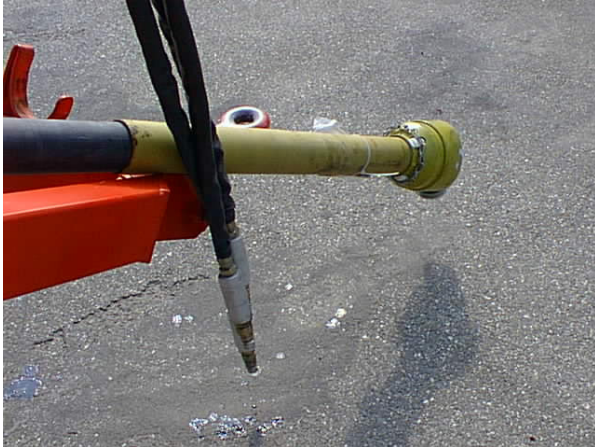
Tubi non vincolati
