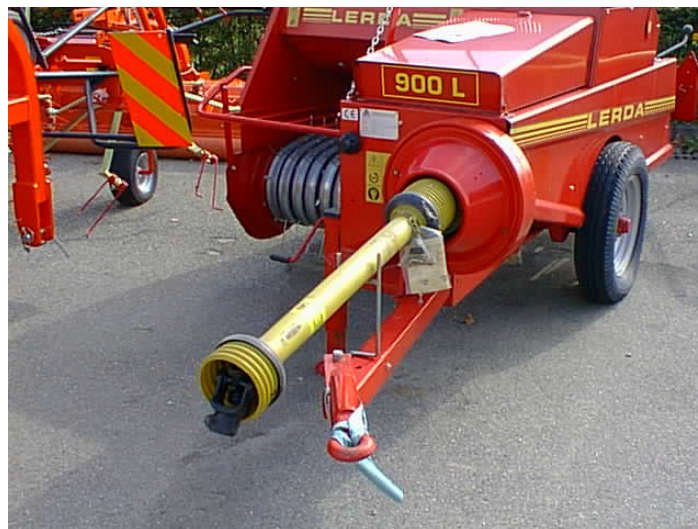
Sistema di trasmissione del moto protetto con albero cardanico e cuffia conformi, supporto a riposo dell'albero e catenelle antirotazione
