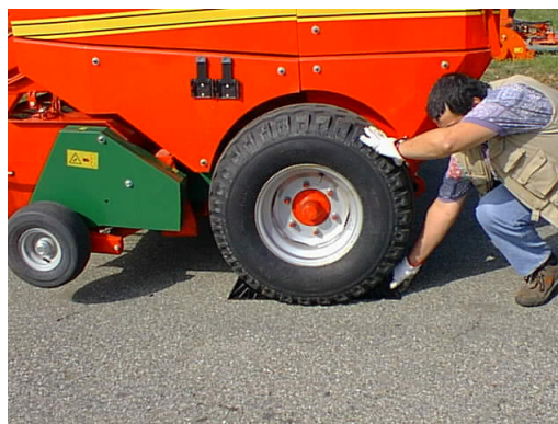
Inserimento cunei di blocco°
