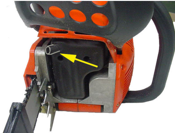
Tubo di scarico rivolto verso l'esterno e il basso
