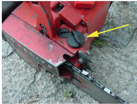
Apertura serbatoio olio
