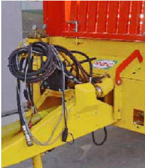
Tubi non vincolati
