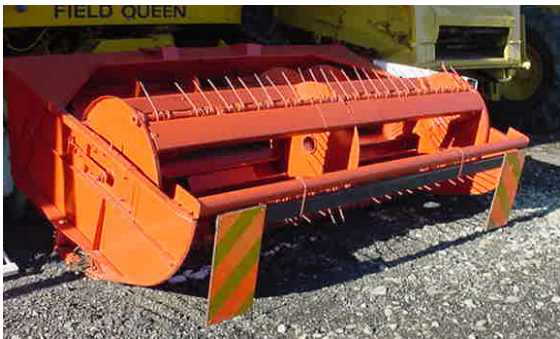
Testata di raccolta con barra distanziatrice frontale
