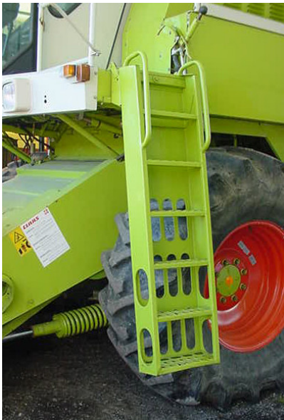
Scala protetta e gradini con superficie antisdrucchiabile
