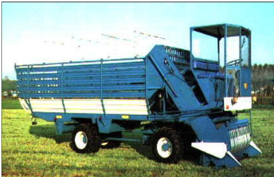
Fig. 2 Esempio di carro falcia-autocaricante semovente
