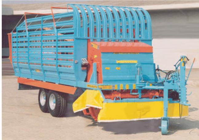
Fig. 1 Esempio di carro falcia-autocaricante trainato
