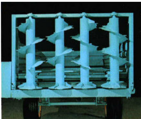
Fig. 3 Spandiletame a scarico posteriore con rotori ad asse verticale
