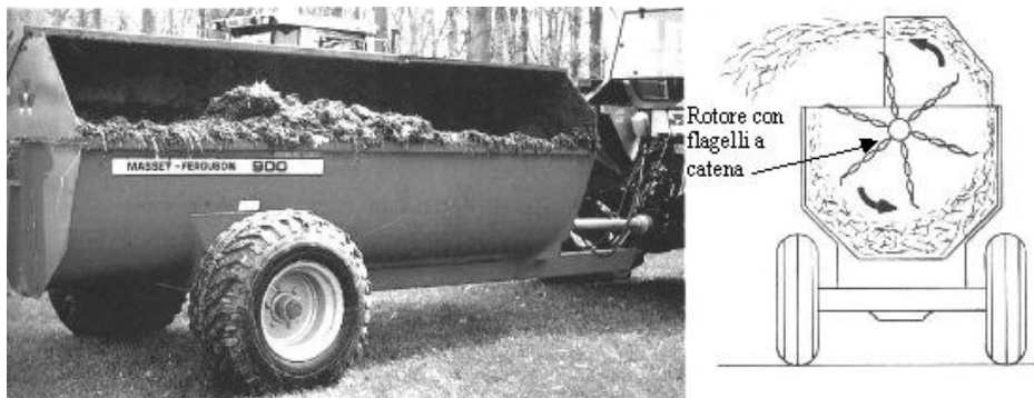
Fig. 2 Spandiletame a scarico laterale con flagelli a catena
