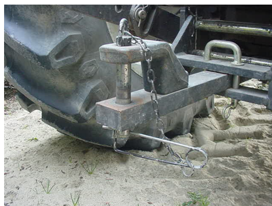
Esempio di spine antisfilo di sicurezza
