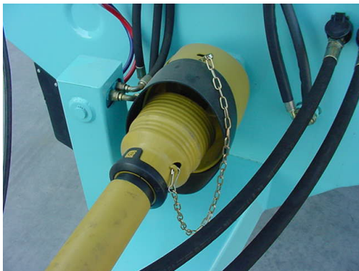
Albero cardanico protetto e supportato
