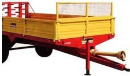
Esempio di dispositivo di protezione anteriore dell'operatore
