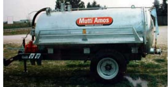
Fig. 4 - Spandiliquame con serbatoio a pressione atmosferica, ad azionamento meccanico
