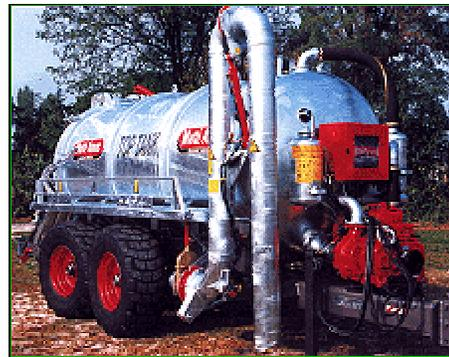
Fig. 3 - Spandilquame con serbatoio in pressione, ad azionamento pneumatico
