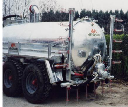
Fig. 9 - Spandiliquame con sistema di distribuzione ad interramento
